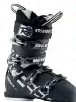
RB12150 ALLSPEED 80 前足幅 102 フレックス 80 サイズ 24-31.5 ウェイト 2,050g(1/2 PAIR) テクノロジー センサーブレード シェル ポリウレタン カフ ポリオレフィン フレックスアジャストメント インナー カスタム T4 GRIPWALKへ交換可能
